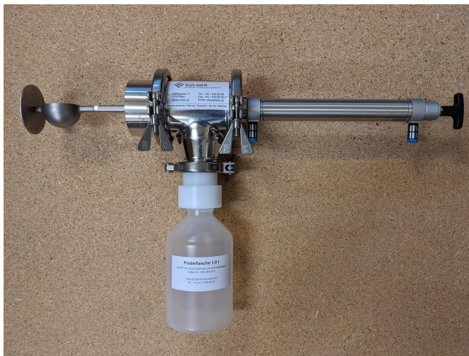
Beispielbild: Tassen-Probenehmer manuell mit Flaschenadapter und 1,0 l Kunststoffflasche
